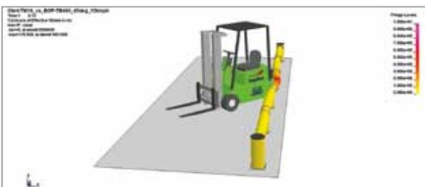
Anhand dieser Testergebnisse entwickelten wir eine Spezialsoftware, die über eine Kollisionssimulation das Verhalten, die Lasten, den Einschlag, die Biegung, die Spannungen und weitere Parameter unserer Produkte vorhersagen kann.
