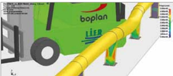
Die Crashtests führen wir mit verschiedenen Geschwindigkeiten und bei verschiedenen Aufprallwinkeln durch. Der Rammschutz hielt jedes Mal den Stößen stand. Der Stapler blieb nach jedem Einschlag in einer sicheren Position stehen.
